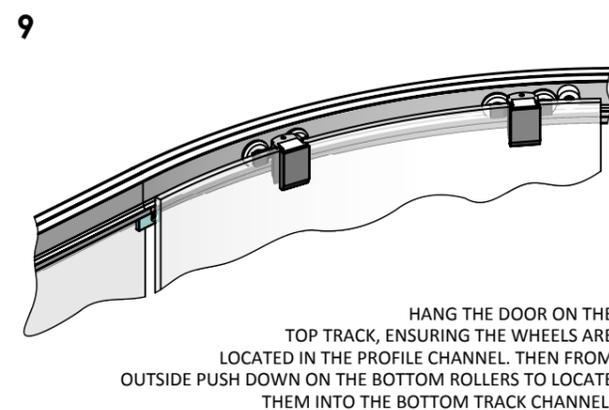
HANG THE DOOR ON THE TOP TRACK, ENSURING THE WHEELS ARE LOCATED IN THE PROFILE CHANNEL. THEN FROM OUTSIDE PUSH DOWN ON THE BOTTOM ROLLERS TO LOCATE THEM INTO THE BOTTOM TRACK CHANNEL.
