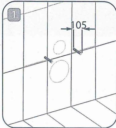
1- Gömme rezervuar içerisindeki bağlantı çubuklarını, resimde görüldüğü şekilde ve ölçüde (105mm) yerleştiriniz, gerektiği durumlarda çubukları kesebilirsiniz.
