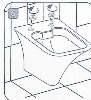
6 - Sonrasında Klozet kapığı montaj aparatlarını Klozeten montajını gerçekleştirdiğiniz yere takın kapak uyumunu sağlayıp montajı tamamlayın.
