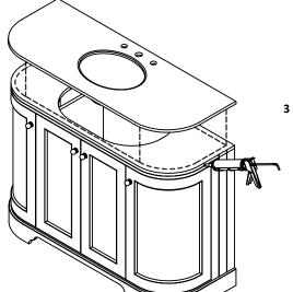
3 RUN A SMALL BEAD OF SILICONE AROUND THE TOP EDGES OF THE CABINET WHERE THE TOP & BASIN SITS. YOU MAY ALSO WANT TO APPLY SOME EXTRA SILICONE OVER THE CABINET'S TOP.
