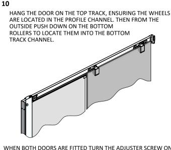
WHEN BOTH DOORS ARE FITTED TURN THE ADJUSTER SCREW ON THE TOP ROLLERS TO LEVEL THE DOORS AND MAKE THEM TRUE TO EACH OTHER.
