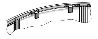
WHEN BOTH DOORS ARE FITTED TURN THE ADJUSTER SCREW ON THE TOP ROLLERS TO LEVEL THE DOORS AND MAKE THEM TRUE TO EACH OTHER.
